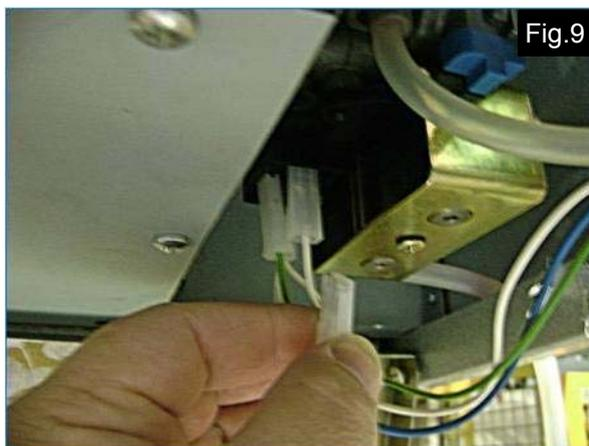
Débrancher le tuyau de gaz de réseau alimentant le rideau d'air, avec l'électrovanne de gaz. Enlever les deux vis de plaque anti-traction (indiquées par des flèches sur la fig. 10). On ne peut enlever le tuyau que vers le bas, avec l'électrovanne de gaz (voir la description ainsi que les fig. 11 et 12 au verso).
