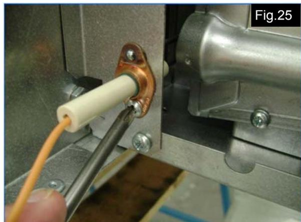
Extraire l'électrode d'allumage avec le câble HT, de la façon illustrée dans la fig. 26.
