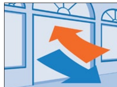
Ogrzewany budynek bez kurtyny powietrznej
