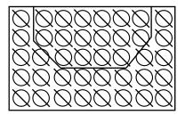
Positions des turbulateurs dans les générateurs 350 et 375 à échangeur de chaleur. Q.té : 28
