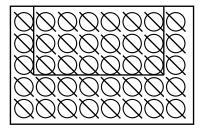
Positions des turbulateurs dans les générateurs 235 et 275 à échangeur de chaleur. Q.té : 40
