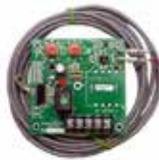
Le limiteur référence **211480** est installé en usine pour surveiller la température de l'air fourni. Le point de consigne de la commande à réinitialisation automatique est réglable. (**REMARQUE:** Inutile pour les commandes numériques, cette fonction est de série sur les contrôleurs numériques.)
