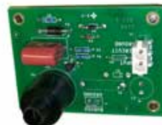
FIGURE 54 – Carte d'allumage à étincelles, référence 257975, située sur le capot amovible à l'extrémité du brûleur.
