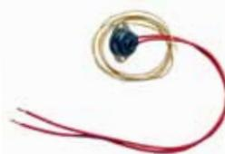
**Fonction:** Le limiteur est un dispositif de sécurité thermique à réinitialisation automatique avec capteur capillaire. Le capteur est placé en travers de la sortie d'air fourni de l'appareil de chauffage.
