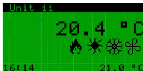
L'écran principal affiche l'information suivante : la température ambiante actuelle, la température de réglage actuelle, l'heure actuelle et le mode de fonctionnement. Le mode de fonctionnement est symbolisé par les images suivantes : chauffage à gaz (🔥), chauffage par pompe à chaleur (★), refroidissement (❄️), ventilation (🌀). Le menu montre aussi la raison du non fonctionnement de l'unité (p.e: en raison de temporisation, en raison de terminal ou en raison d'alarme).
