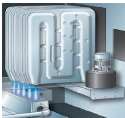
standardowy wymiennik ciepła, model SDH oraz RDH, również główny wymiennik ciepła, model SHH oraz RHH
