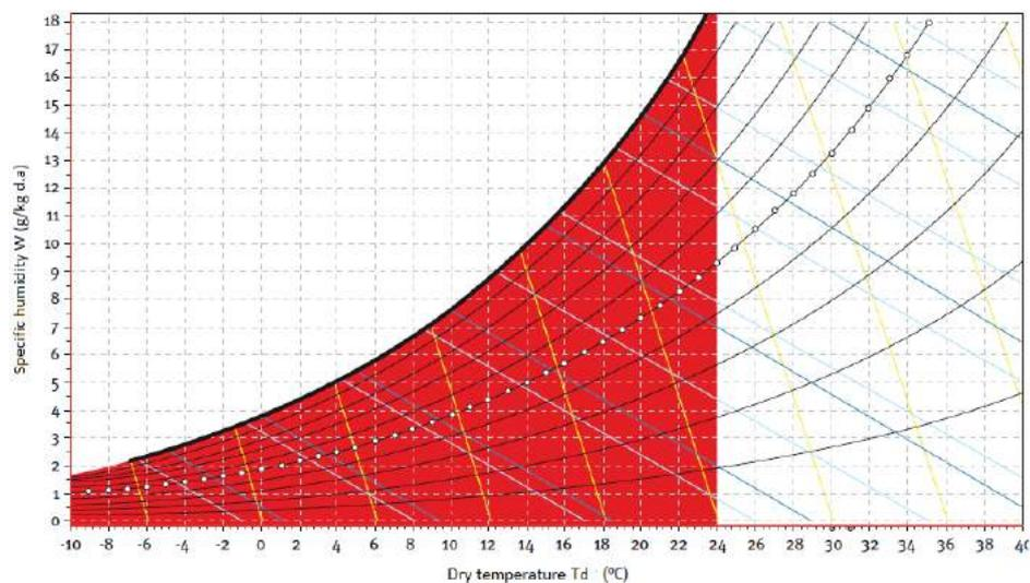
External conditions where the thermal free-cooling actuates. Internal conditions 24 °C and 50% of relative humidity. Source: (Guía Técnica de Ahorro y recuperación de energía en instalaciones de climatización, IDAE 2010).
