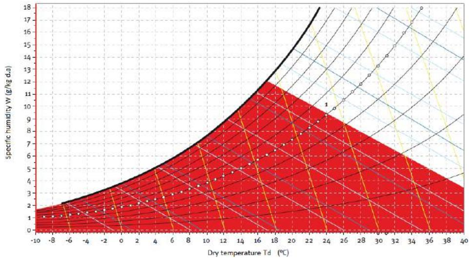
External conditions where the pure enthalpy free-cooling actuates. Internal conditions 24 °C and 50% of relative humidity. Source: (Guía Técnica de Ahorro y recuperación de energía en instalaciones de climatización, IDAE 2010).
