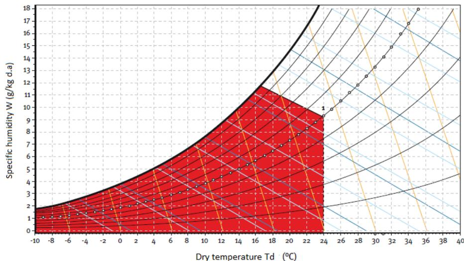
External conditions where the improved enthalpy free-cooling actuates. Internal conditions 24 °C and 50% of relative humidity. Source: (Guía Técnica de Ahorro y recuperación de energía en instalaciones de climatización, IDAE 2010).
