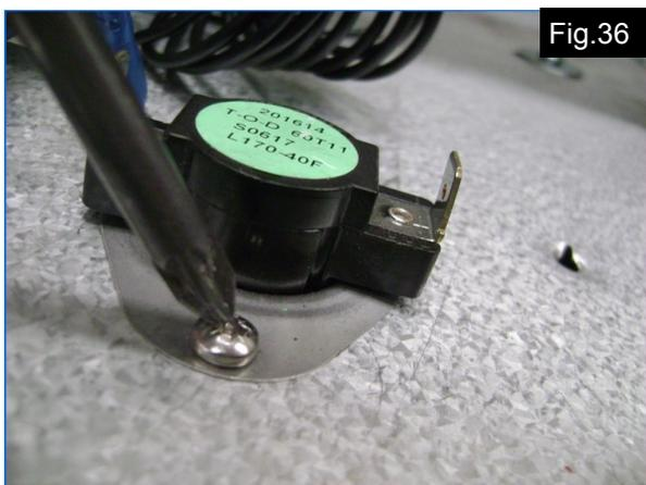
Détacher les connexions de l'interrupteur à réarmement manuel comme indiqué dans la
