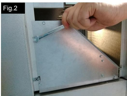
Enlever les écrous du couvercle du conduit d'évacuation comme illustré dans la fig. 3 en ayant soin de ne pas endommager le joint.
