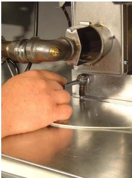
Figuur 21 Verwijder de 2 moeren van het branderrek
