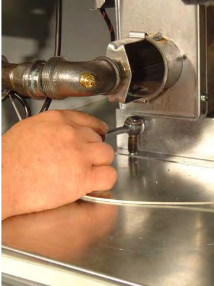
Figuur 21 Verwijder de 2 moeren van het branderrek
