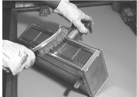
Enlever une des plaques d'extrémités dans le cas où le brûleur est très sale. Enlever les quatre vis qui attachent la plaque d'extrémité au caisson brûleur. Taper légèrement sur la plaque d'extrémité afin de l'enlever.
