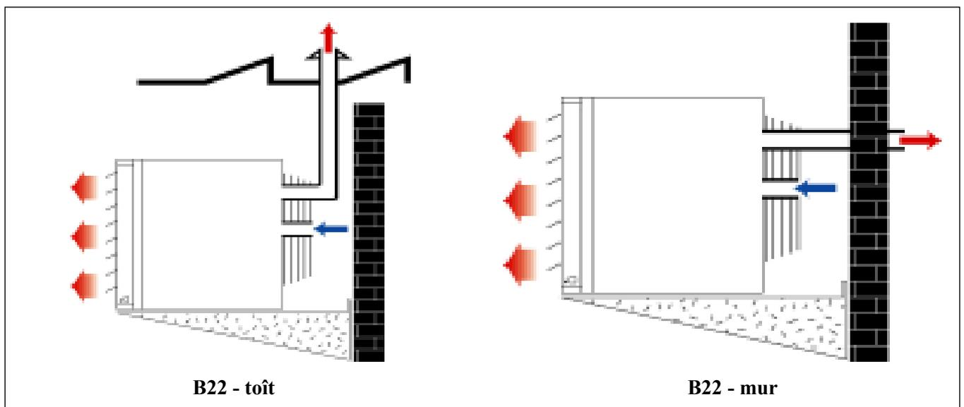
**Figure 3b : Installation type B : Raccordements conduits d'arrivée d'air comburant et d'évacuation des gaz brûlés**
