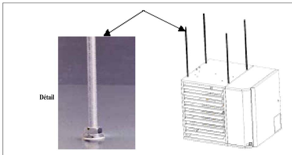
S'assurer que les tiges filetées soient montées selon la figure 6. La longueur maximale est de 1,8 m. Bloquer la tige filetée à l'aide d'un contre écrou en serrant modérément afin de ne pas endommager le filetage de l'insert.
