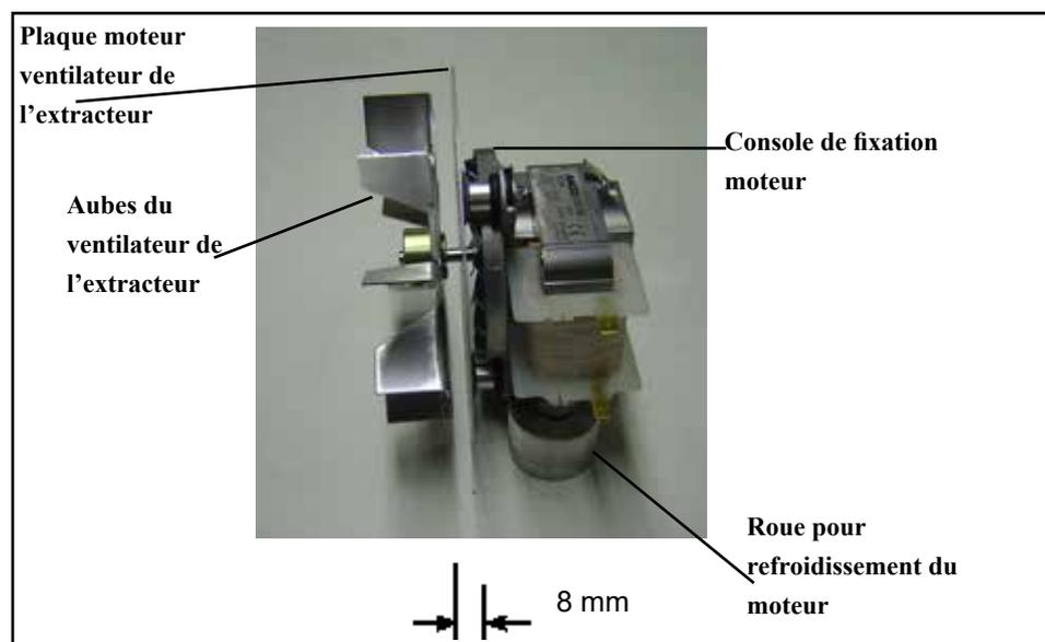
**Figure 19 : UDSA mod. 025-4E→030-4E/032-4E (sens de rotation : tournant dans le sens horlogique vu de l'extrémité de l'axe)**
