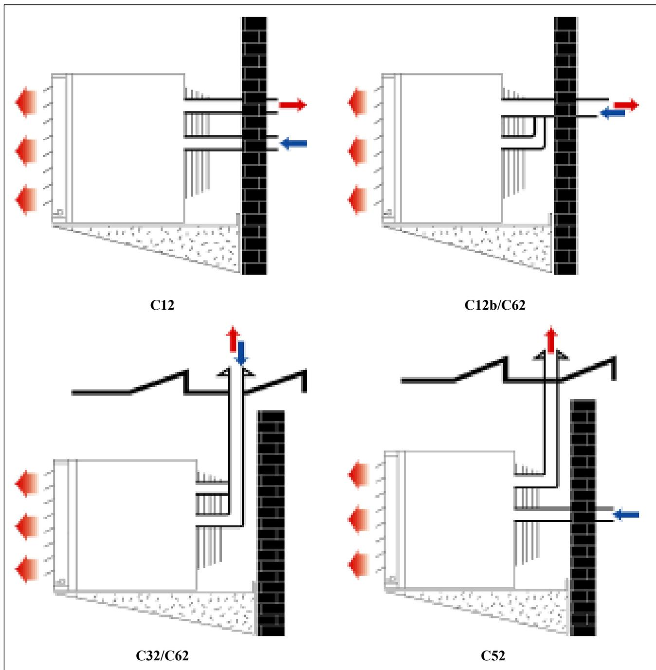
**Figure 5 : Applications Type C : Raccordements conduits d'arrivée d'air comburant et d'évacuation des gaz brûlés**
