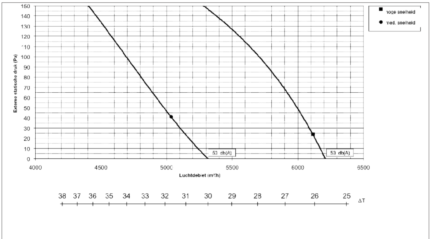
Figuur 2f : ventilatorcurve UDSBD 055-4E
