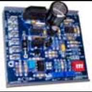
FIGURE 32B – Conditionneur de signal utilisé dans les options AG21 et AG40
