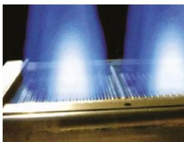
La technologie brevetée centre la flamme par rapport à l'échangeur, évitant le contact et la rupture de l'échangeur.
