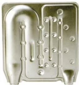
Les versions SHH et RHH sont aussi équipées d'un échangeur secondaire MacroChannel en aluminium, monté en aval de l'échangeur primaire. Grâce à la condensation des gaz de combustion, le rendement thermique est augmenté à 102% (PCI).
