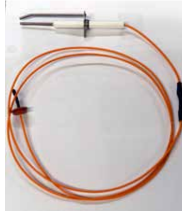
Vonksonde Lengte van de sonde = 78,5 mm lange sonde 42,3 mm korte sonde 3.5 \pm 0.5 mm spleet tussen sondes Sondehoek = 20^\circ
