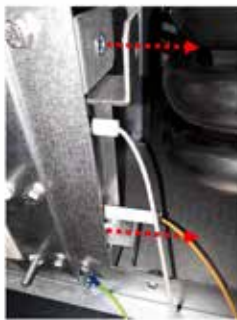
Verwijder de sondebevestigingsbeugel uit de kamer
