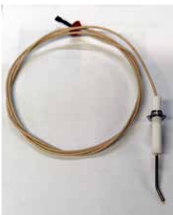
Vlamsonde Lengte van de sonde = 46,55 mm totaal 32,95 mm tot hoek 13,79 mm hoek tot tip Tipafbuiging van 0^\circ = 27^\circ
